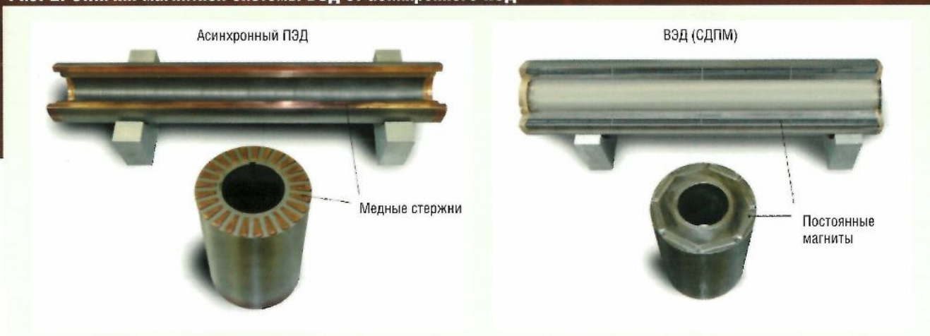
Рис. 2. Отличия магнитной системы ВЭД от асинхронного ПЭД
