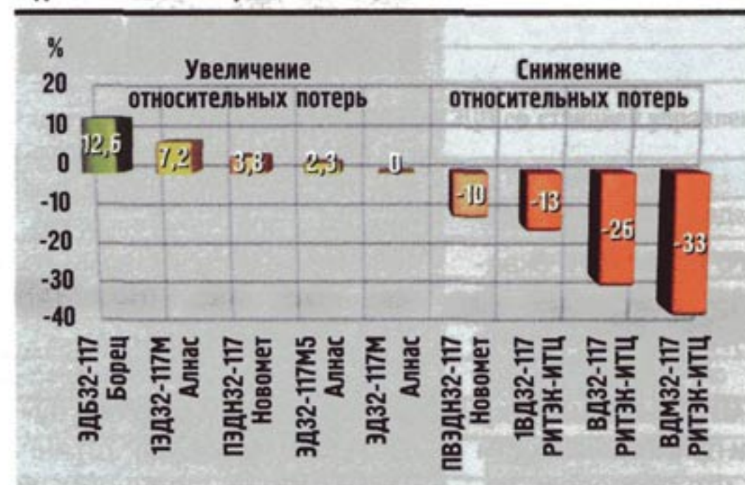
Диаграмма относительных потерь в приводах с двигателями мощностью 32 кВт
